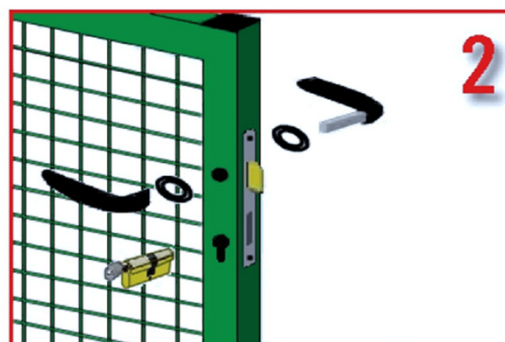
2 - Inserire la maniglia e il cilindro
